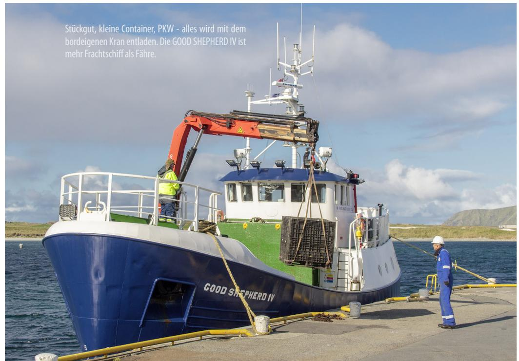
Stückgut, kleine Container, PKW - alles wird mit dem bordeigenen Kran entladen. Die GOOD SHEPHERD IV ist mehr Frachtschiff als Fähre.
