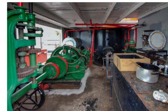
Boilerroom mit Dampfmaschine, Arbeitsplatz des Donkeyman
