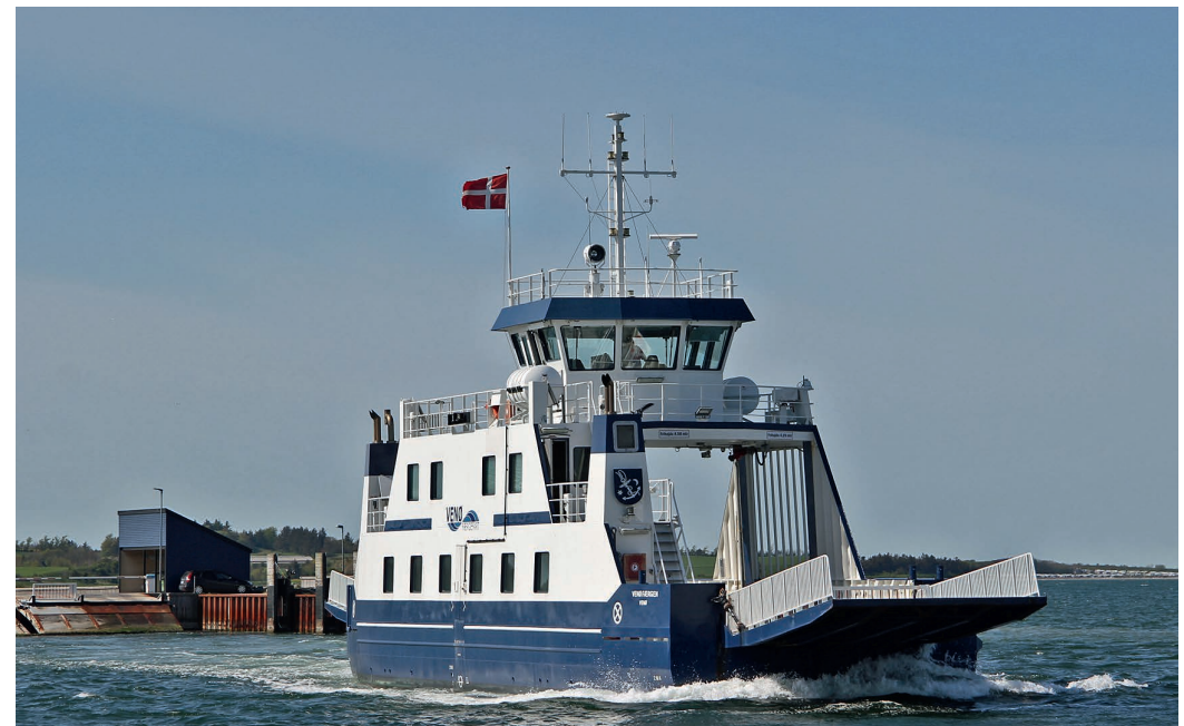
Die VENØFÆRGEN ist der kleinste und kürzeste Doppelender dieses Tages und passt damit gut zur sehr kurzen Überfahrt zur Insel Venø. Neben ihren beiden modernen Anlegerampen sind auch noch die alten Anleger vorhanden, die bei Einsatz eines Ersatzschiffes wieder benutzt werden.
