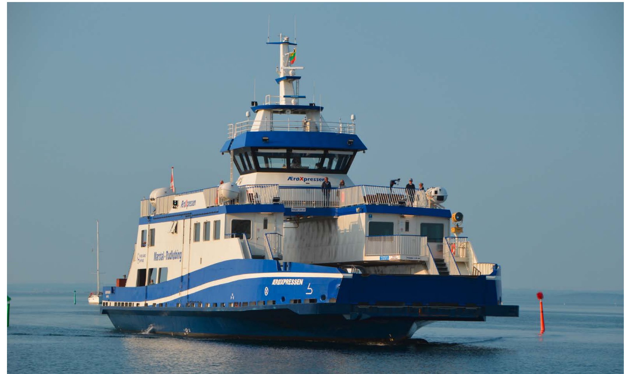
Die ÆRØXPRESSEN im Oktober 2021 auf dem Weg von Rudkøbing nach Marstal. Noch ist die 2019 in Hvide Sande fertiggestellte Fähre mit einem Hybridantrieb unterwegs. Sowohl zwei von Scania-Dieselmotoren angetriebene Generatoren als auch ein Batteriepack mit 316 kWh liefern den Strom für die beiden elektrischen Fahrmotoren. Foto: Ralph Christian Schöttker
