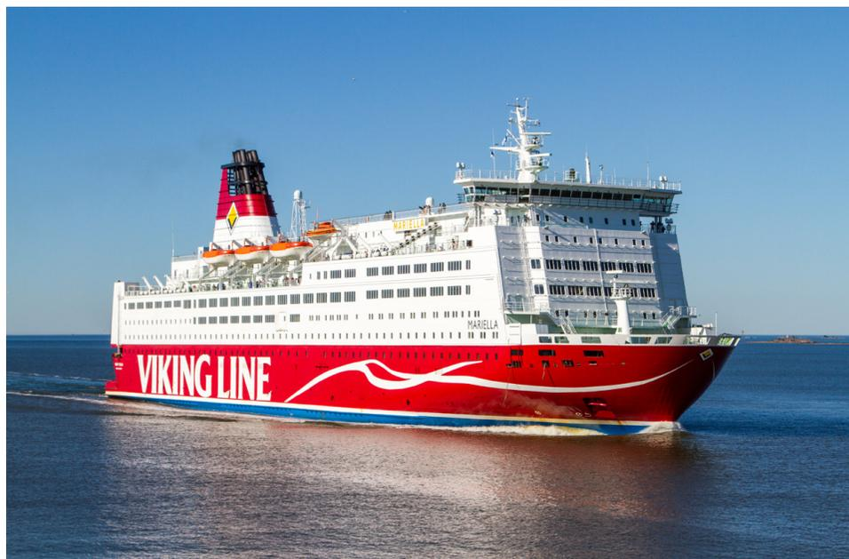
► Um auf den 2000 erfolgten Umbau der Innenbereiche aufmerksam zu machen, wurde der MARIELLA außen ein Hinweis „aufgestempelt“. Neben den Umbauten im Inneren erhielt das Schiff die Ducktails am Heck, MED-Stationen auf dem Bug sowie Ausschnitte im Schanzkleid für eine bessere Sicht.
