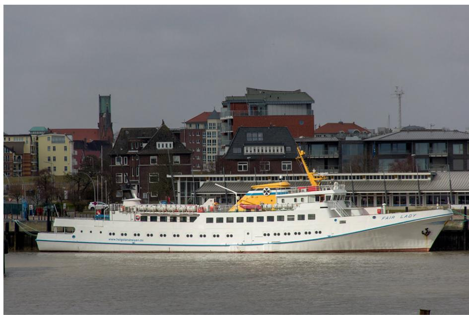
▽ Das Logo am Anleger in Cuxhaven ist noch von 2017 übrig geblieben. Gut zu erkennen ist das hinter der leicht abfallenden Rampe ansteigende Fahrzeugdeck der GREENFERRY I. Dadurch laufen lange oder tiefliegende Trailer Gefahr aufzusetzen. Nur im Schrittempo rollte der Traktor-Transport auf die Fähre.
