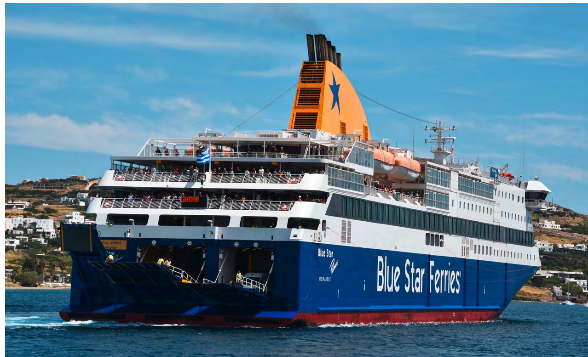
Die BLUE STAR PATMOS legt in Naxos ebenfalls mit den Heckklappen voraus an. Wie üblich erreichen und verlassen nicht nur Fahrzeuge die Fähre über die Rampen, auch der Passagierwechsel wird über diesen Zugang abgewickelt.
