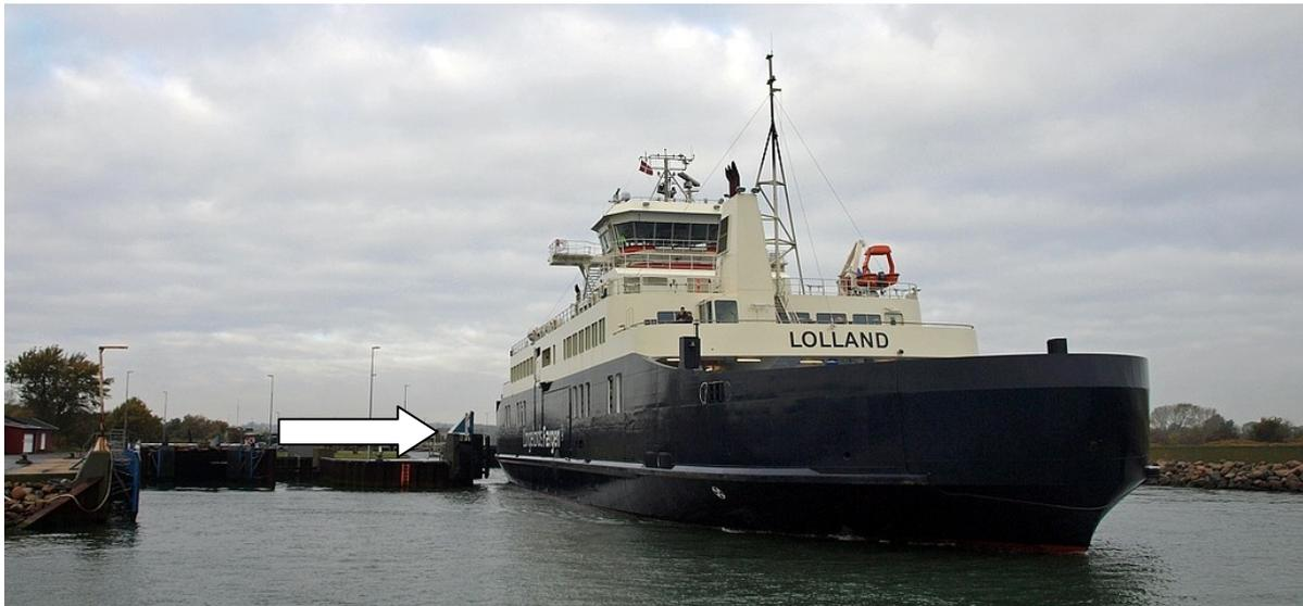
*In Spodsbjerg bemerkte Martin Kursawe, dass die **LOLLAND** mittlerweile das von der **KANHAVE** in Hov und Sælvig bekannte Vakuum-Festmachsystem benutzt. Auf diesem Bild ist es für das geübte Auge neben dem Schiff zu erkennen (Pfeil). Die **LANGELAND** dagegen (Bild unten) hielt sich mit den Thrustern auf Position.*
