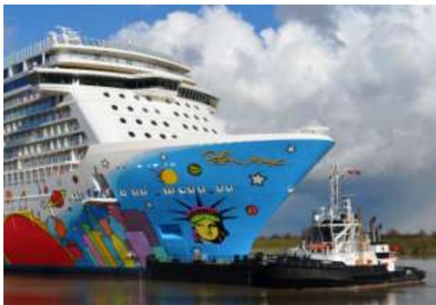
Weg nach Eemshaven. Die Meyer-Werft benutzte erstmalig bei einer Ems-Überführung einen Ponton als Manövrierhilfe, der quer am Schiffsbug vertäut "mitlief". Ein Schlepper hatte ebenfalls festgemacht und konnte so effektiver als ein Bugstrahlruder auf der engen Ems assistieren. Photos: Jan-Otto Schaumann
