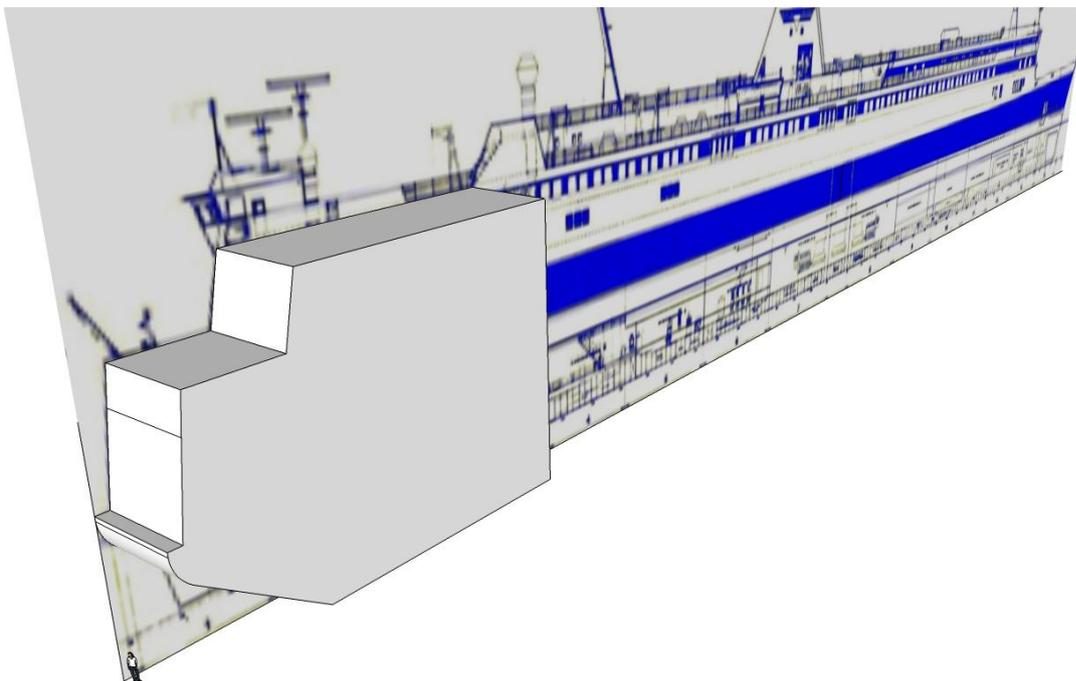
Nun kann der eigentlich Bau beginnen. Da sich die Steuerbord- & Backbordseite von Schiffen meistens gleichen, bietet es sich in der Regel an, ein „halbes“ Schiff zu bauen und später dann den Rest einfach zu spiegeln und somit das Schiff zu komplettieren. Diese Vorgehensweise spart nicht nur Zeit, sondern stellt auch die richtigen Proportionen sicher. Mit
