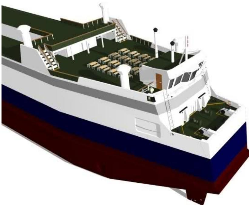
Sind alle Bereiche, die sich sowohl auf der Steuerbord- als auch auf der Backbordseite gleichen, modelliert, kopiert und spiegelt man das Modell, wie oben bereits erwähnt, und sieht somit das Schiff das erste Mal in der ganzen Größe. Nun baut man die Bereiche, die sich bei den verschiedenen Schiffsseiten unterscheiden. So sind bei dem Modell der *MS KARL CARSTENS* Lüftungsgitter, Antennen und Masten nicht symmetrisch angeordnet und können erst jetzt hinzugefügt werden.
