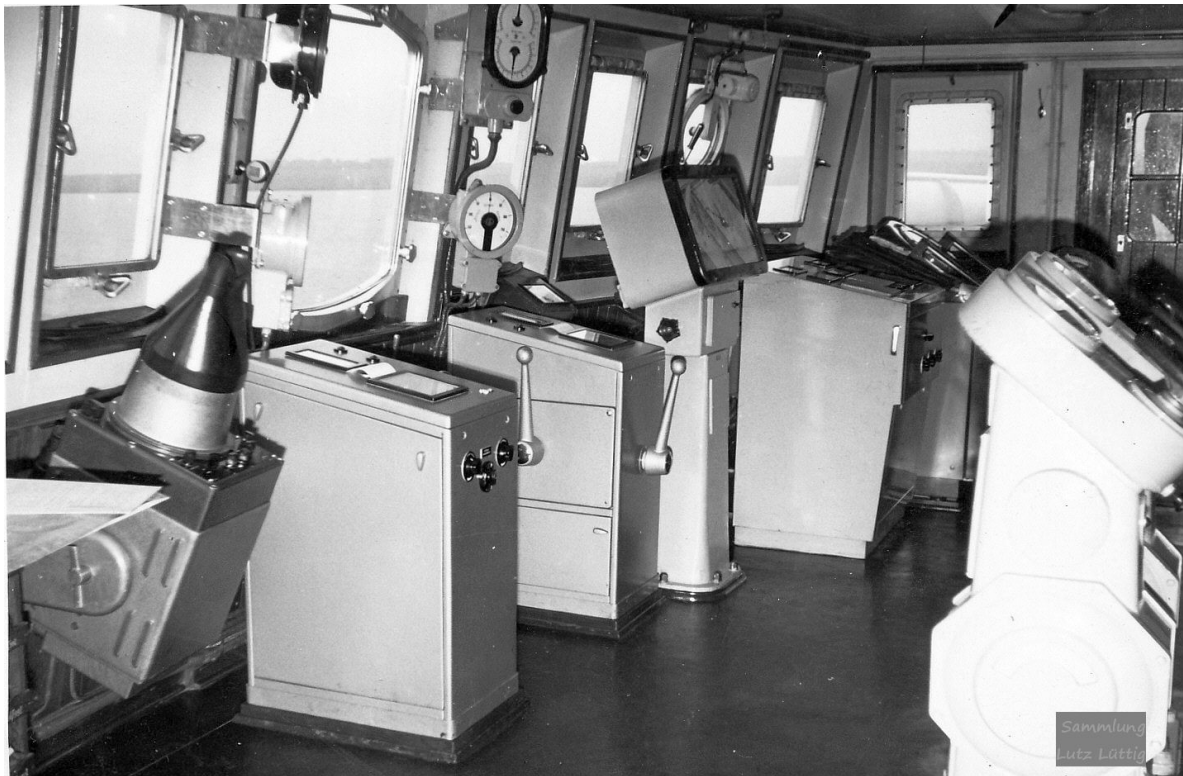
Blick auf die Kommando-Brücke der DEUTSCHLAND . Die beiden Kästen vor dem großen Fenster dienen vermutlich zur Steuerung des Voith-Schneider-Antriebs, mit dem das Fährschiff ausgerüstet war. Rechts am Bildrand das Ruder. Photo: Sammlung Lutz Lüttig
